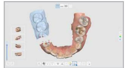
Escanee con su propia estrategia de escaneo. Los datos de escaneo fragmentados se alinean con el área común detectada automáticamente.
